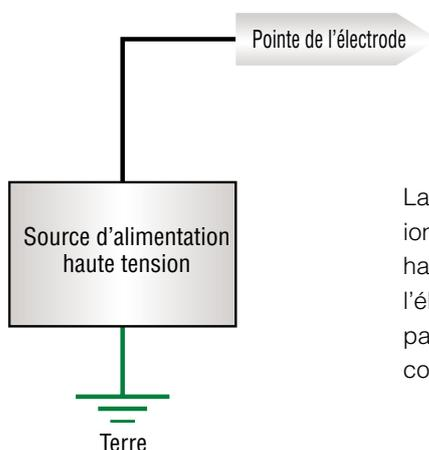
La terre (mise à la terre) fournit les électrons qui serviront de base aux ions. Les électrons fournis sont stimulés par la source d'alimentation haute tension afin de produire des ions à partir de la pointe de l'électrode. Ce système se différencie ainsi du système à auto-décharge par sa source d'alimentation haute tension générant des ions en continu.
